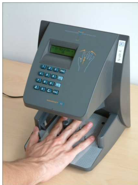
Rysunek 10: Czytnik geometrii dłoni HandKey II firmy Recognition Systems, Inc.
